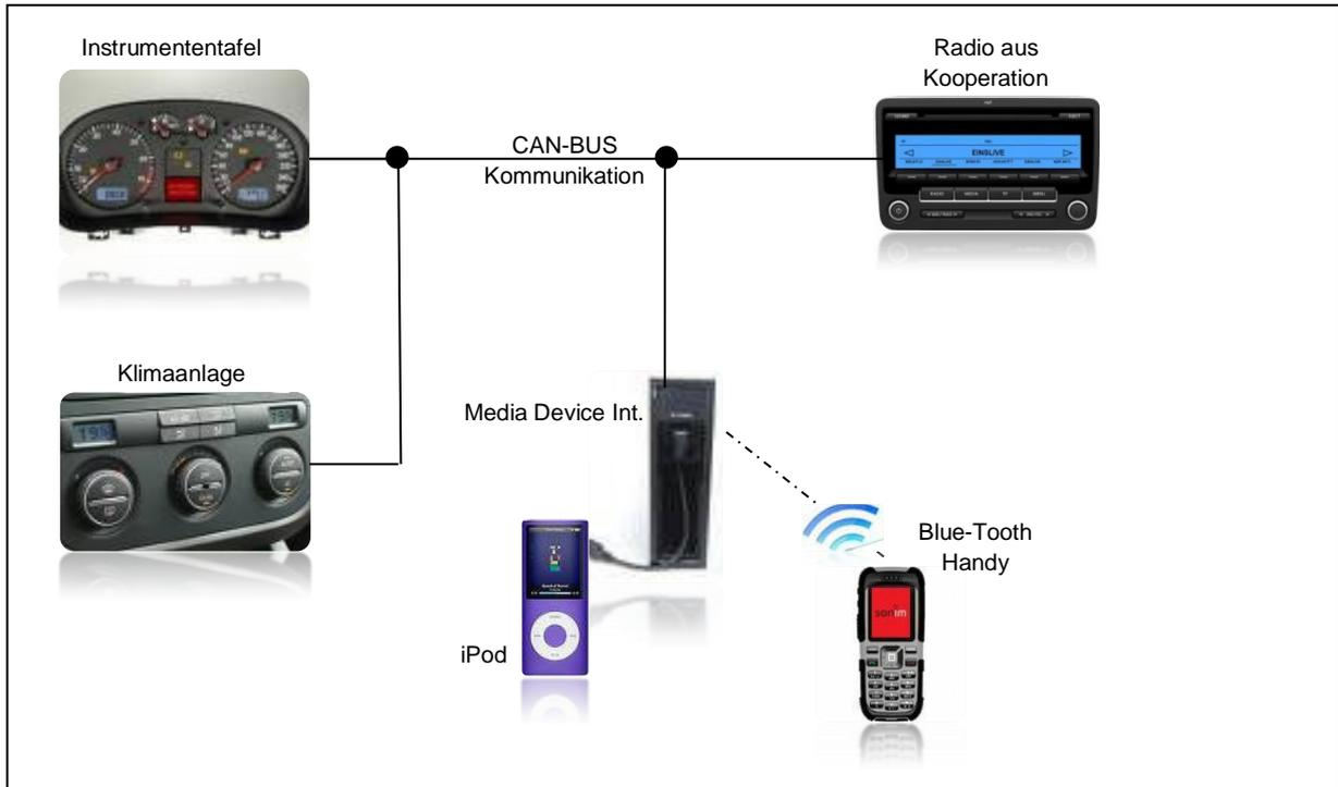
Abbildung 5: Vernetzung der Steuergeräte mit dem Radio im Fahrzeug
